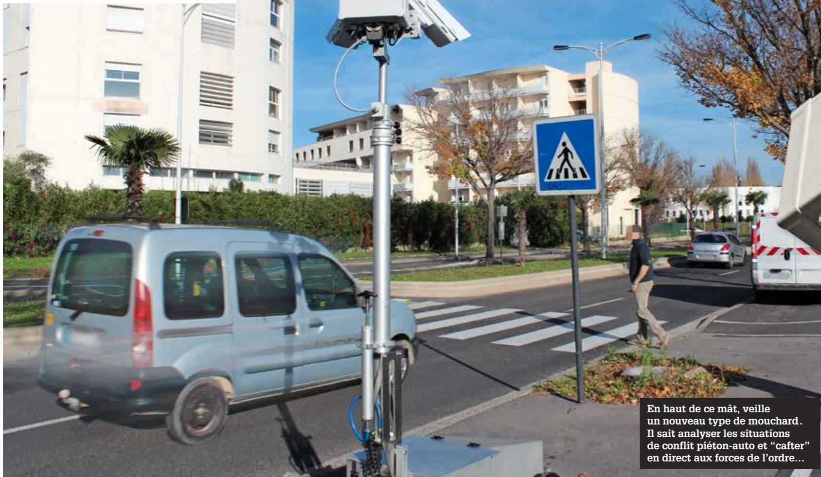
Une fois replié, l'engin loge dans une camionnette. Ce qui le rend très déplaçable. Notez que le dispositif fonctionne soit sur batteries, soit en "s'amarrant" à un poteau d'éclairage public, dont il peut récupérer l'alimentation électrique.
