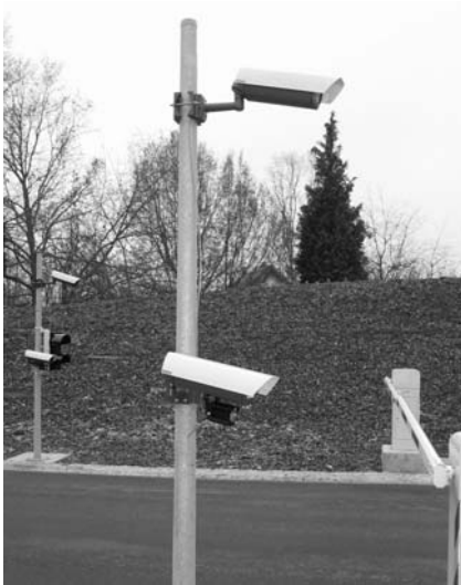
Die Kennzeichenkamera in Verbindung mit einem IR-LED-Strahler bringt zu jeder Tages- und Nachtzeit gestochen scharfe und kontrastreiche Bilder.
